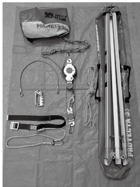
写真1 ロールグリスR350と使用する資機材
