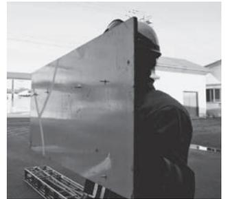
写真7 ツメ付敷板の地面側。木ネジはスパイクの代わりにします
